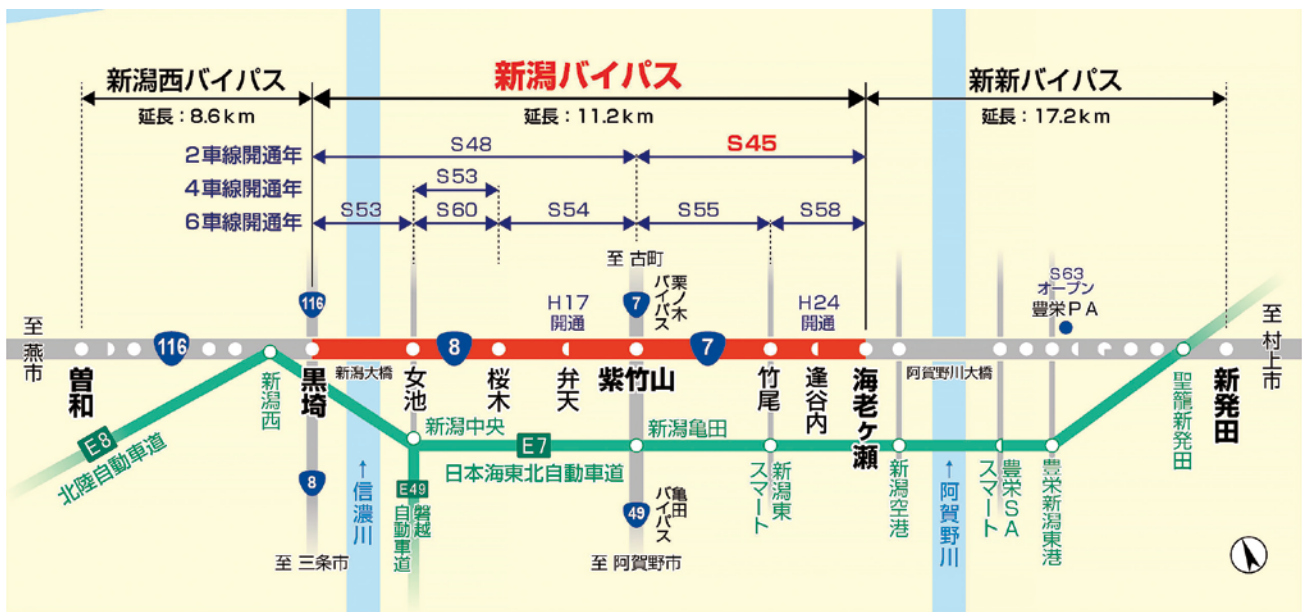
図-4 新潟バイパスネットワークの概要 (出典：新潟国道事務所 3) )
