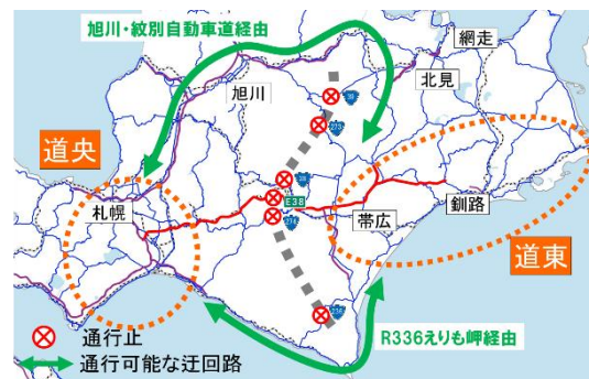
図-3 台風 10 号接近時の不通・通行止め状況（道央～道東間） （出典：国土交通省北海道開発局資料）
