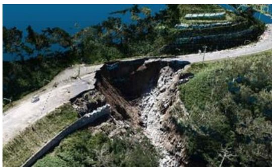
写真-2 被災状況の把握におけるUAV(ドローン)の活用 (出典:国土交通省北海道開発局資料)
